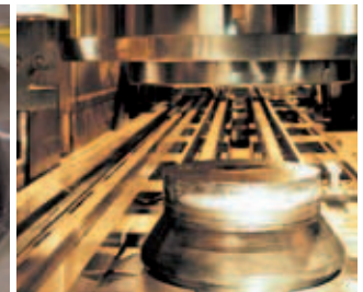
Compaction de gaines et embouts, résidus du retraitement de combustible nucléaire irradié
