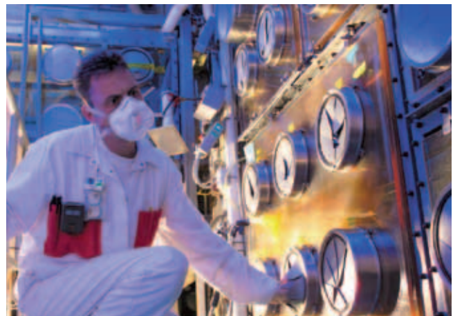
Boîte à gants utilisée pour la fabrication de combustibles nucléaires
