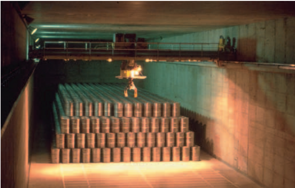
Les déchets de catégorie B sont entreposés dans des bunkers ventilés. Pour l'empilement des déchets, les bâtiments d'entreposage sont équipés de ponts roulants commandés depuis une salle de commande blindée.
